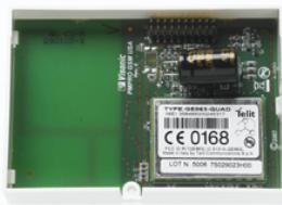
GSM komunikator za **POWERMAX PRO** alarmnu centralu. Napajanje 220V i back up baterija. Potpuni nadzor stanja ispravnosti.
