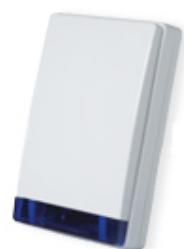
Bežična vanjska sirena za **POWERMAX PLUS**, dvosmjerna komunikacija za potpuni nadzor stanja baterije, statusa, tampera, dodatno napajanje (baterija), 100dB, vodootporna (IP55) signaliziranje uklj-isklj sustava. MCS-710 koristi samo dugotrajanu bateriju bez mrežnog napajanja 220V (trajanje baterije do 3 godine) (SAMO ZA POWERMAX+ )
